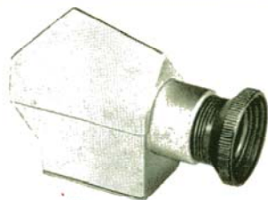
Til højre: Den otte gange forstørrende lup virker som en lysskakt, der holder falsk lys borte fra matskiven på alle sider. – Til venstre: Pentaprisme (seks gange). Begge hjælpemidler kan skydes på i stedet for rammesøgeren (Lysskakt og samtidig gennemsigtsøger med lysramme)
